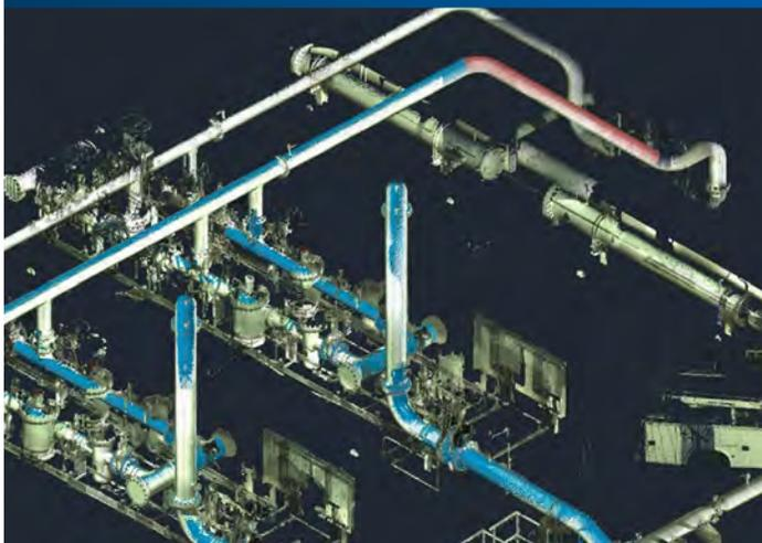
建築設計や改修プロジェクトにおいて、オンデマンドで正確な現況データを生成します。より正確で包括的なデータにより、設計が機能することを確認できます。また、仮想オーバーレイと現況データを比較して、クリアランスチェックや対立検知を実施して、設計を検証できます。
