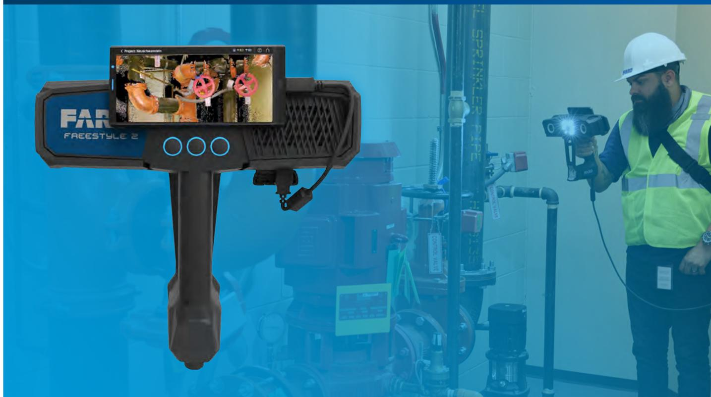
FARO Freestyle 2 ハンディスキャナーは、複雑な建設プロジェクトに最適な、軽量かつ機動性に優れたモデルです。単独で使用することも、FARO Focus Laser Scannerと組み合わせて使用することも可能です。ハンディタイプなので、狭い場所や散らかった場所など、他の方法では届きにくい場所でも簡単に操作でき、複雑なディテールを正確に記録することができます。
