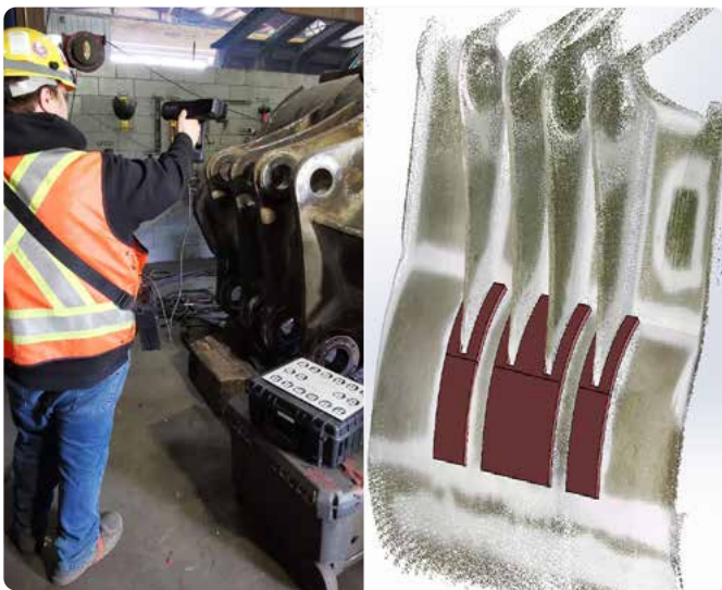
重型采矿设备通常采用复杂的弯曲部件，很难手动测量。图为需要翻新的 Hitachi 挖掘机铲斗。
