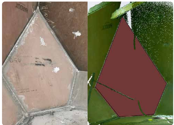
Pieza de una esquina complicada del proyecto de una caja de camión de transporte. Después de usar su escáner láser Freestyle 2, el equipo ajustó a la perfección la pieza cortada en el primer intento sin necesidad de repetir ningún trabajo.
