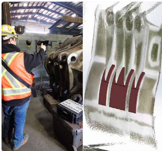
Equipamentos de mineração pesada frequentemente têm peças curvas e complexas, difíceis de medir à mão. Nesta foto há uma caçamba de escavadeira Hitachi que precisa ser recondicionada.
