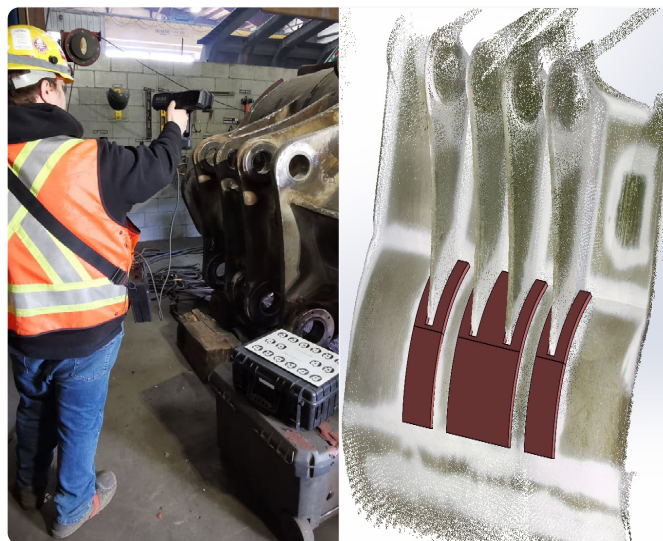
Le attrezzature pesanti per l'estrazione mineraria hanno pezzi complessi, curvi, difficili da misurare a mano. Nella foto vediamo una benna per escavatore Hitachi da ricondizionare.
