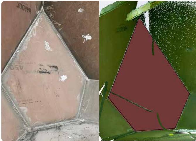
*Ein kompliziertes Eckteil aus dem Muldenkipper-Projekt. Unter Verwendung seines Freestyle 2-Laserscanners konnte das Team bereits beim ersten Versuch ein perfekt zugeschnittenes Teil anbringen. Nacharbeiten wurden auf diese Weise obsolet.*
