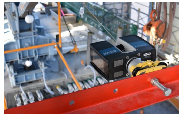
안쪽에 보이는 다리 거더의 단면을 포인트 클라우드 측정 중인 Focus s 350. 가로 방향으로 설치함으로써 측정 시에 생길 수 있는 사각지대를 방지하고 있다.
