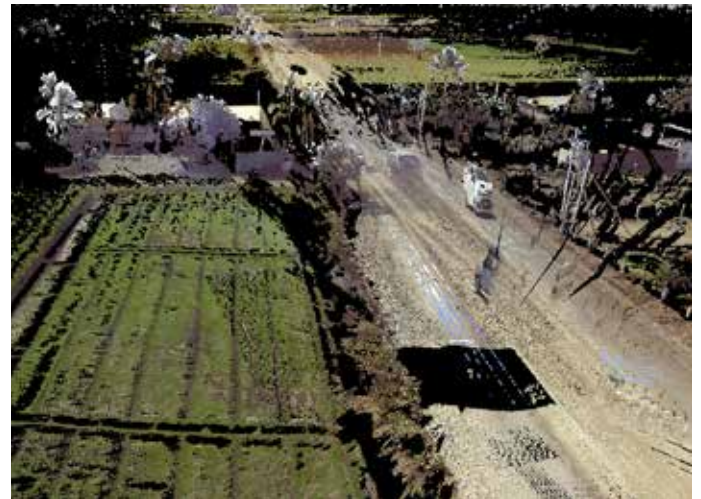
FARO Focus s 330을 사용하여 마하라슈트라 지역의 미개발 도로에서 얻은 3D 포인트 클라우드 데이터
