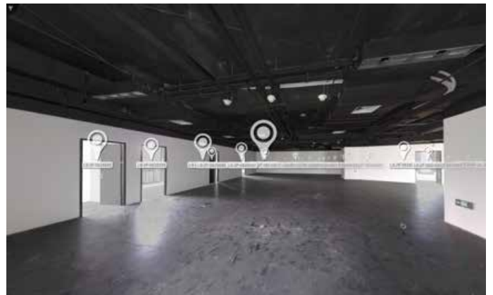
사무실 건물 프로젝트에서 FARO 3D 레이저 스캐너로 캡처한 스캔 버전.
