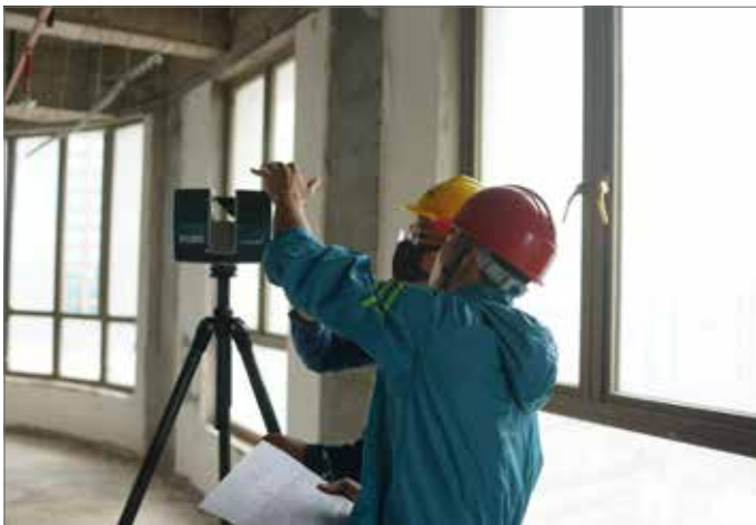
FARO 3D 레이저 스캐너를 이용한 실내 스캔.
