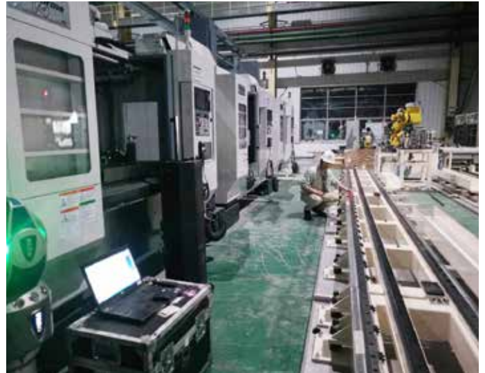
차량 도어 조립 라인의 컨베이어 가이드 레일의 현장 검사
