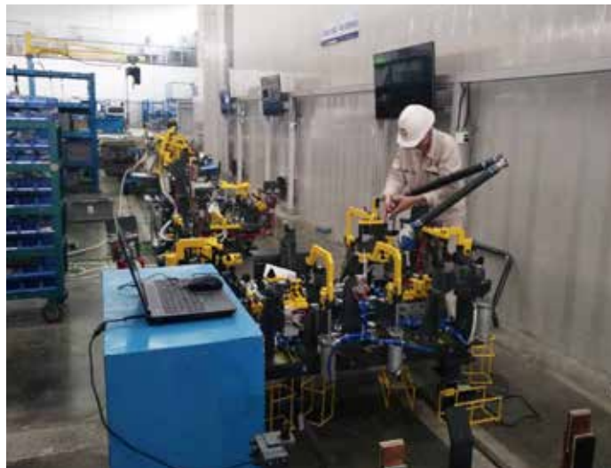
작업자가 라인에서 부품 검사를 수행할 수 있도록 지원하는 휴대용 FaroArm
