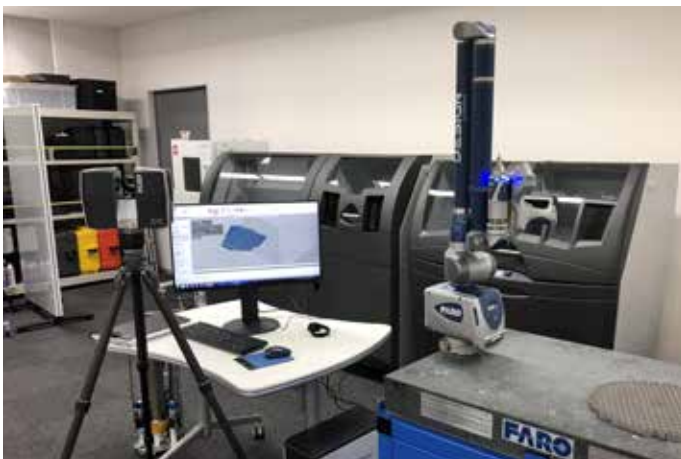
Gcube는 새로운 사업을 구상하기 위한 노력에 집중하기 위해 Focus 3D 및 Design ScanArm을 3D 프린터 2대에 연결하여 기능을 극대화했습니다.
