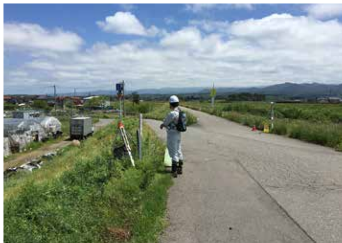
Focus 3D X 330을 통한 제방 측정.
