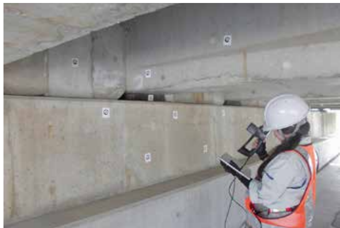
작업자는 편리한 Freestyle 3D X를 사용하여 주변영역의 상세한 스캔을 확보합니다(예:다리 지지대)
