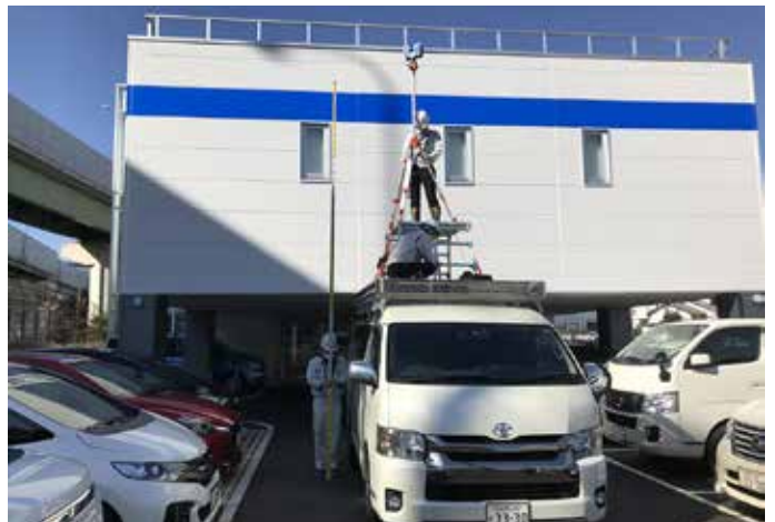
차량에 설치된 주문제작 비계를 통해 Okumura Sekkei는 더 적은 스캔으로 6m 높이에서 대형 구조물의 데이터를 얻을 수 있습니다.
