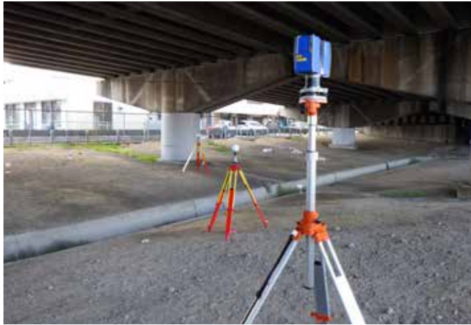
Focus 3D X 330 및 여러 표적을 사용하여 전체 환경 스캔.
