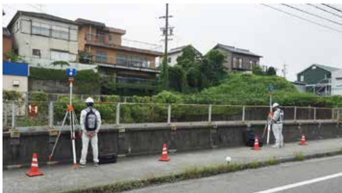
Focus 3D X330을 사용하여 포인트 클라우드 데이터를 수집하는 작업자.
