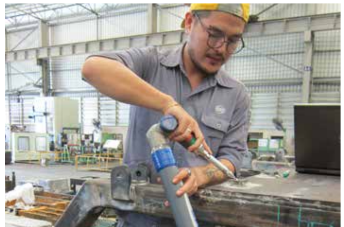
휴대성이 뛰어난 FaroArm을 사용하면 작업 현장 어디서나 측정이 가능합니다.
