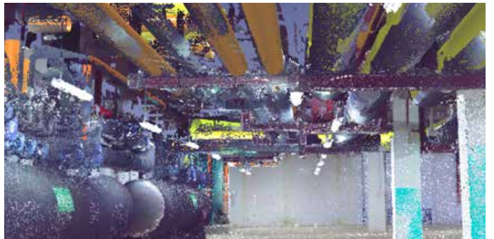
위:FARO Focus 3D 로 확보한 공장의 포인트 클라우드 데이터. 아래:포인트 클라우드 데이터를 기반으로 생성된 추출 모델.
