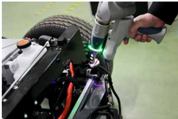
FARO Edge ScanArm HD를 사용한 전기차 플랫폼 측정.
