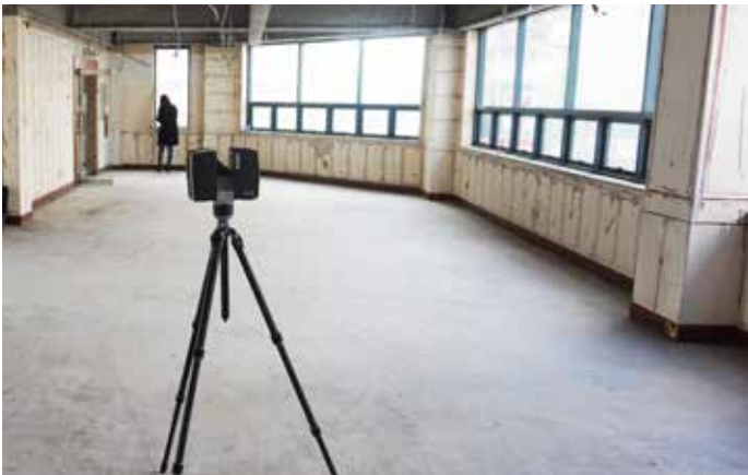
FARO 레이저 스캐너인 Focus 3D X 130을 이용해 건물을 스캔하고 있는 모습.
