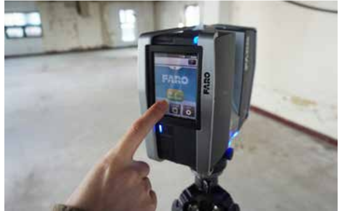
Focus 3D 장비에 내장된 터치스크린을 통해 간편하게 장비 조작
