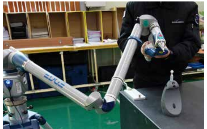
사람 팔 모양의 FARO Edge ScanArm HD를 사용중인 모습 - 사각지대 없이 자유자재로 활용
