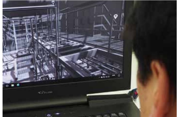
Focus 3D X 130을 통해 획득한 포인트 클라우드 데이터로 만들어진 3D 모델을 활용하여 작업하는 기술자.
