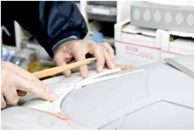
풍동 시험을 위해 3D 부품을 1/5 모델에 부착하는 과정입니다. 이를 통해 Mooncraft는 더욱 빠르고 안전한 자동차를 제작함.
