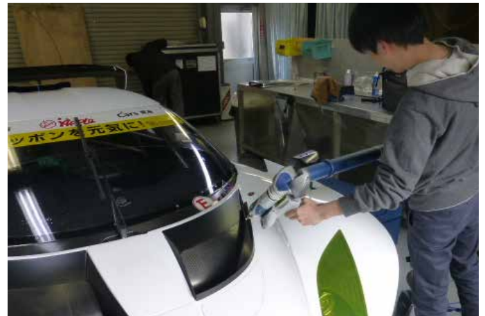
Mooncraft 직원이 FARO Design ScanArm을 사용하여 경주용 자동차 부품을 스캔하는 방법을 보여줍니다.
