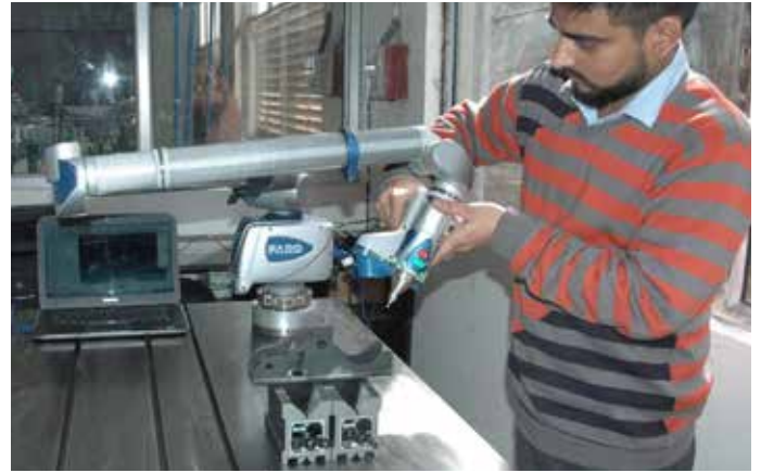
직원이 제품 검사에 FARO Edge ScanArm HD가 어떻게 사용되는지 시연하고 있습니다.
