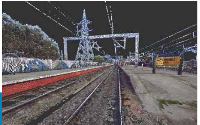
FARO Laser Scanner Focus 3D X 330으로 획득한 스캔 데이터.
