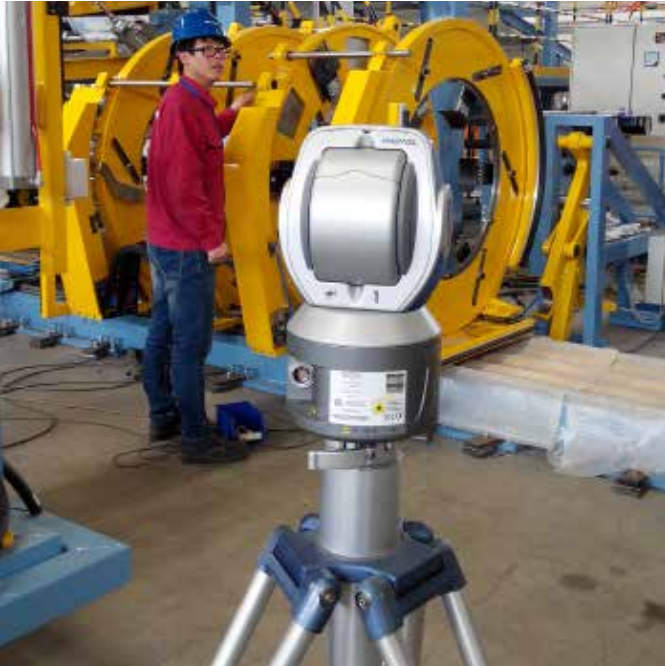
FARO Laser Tracker Vantage로 장비의 위치 구멍을 측정합니다.
