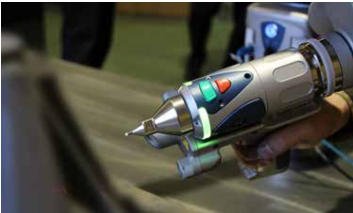
짧은 시간 내에 현장 측정을 간편하게 할 수 있는 휴대용 FARO Edge ScanArm ES.
