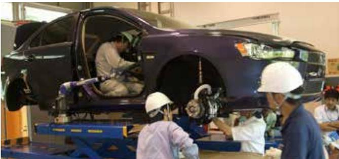
좁은 공간에 대한 접근성이 뛰어난 FaroArm은 자동차 내부 측정에도 매우 유용한 것으로 검증되었습니다. 위 사진은 전기 부품 배치를 위해 콘솔 박스 측정에 FaroArm을 사용하는 방법을 보여줍니다. 프로젝트 진행 시 FaroArm은 다양한 모양과 크기의 항목 측정, 충돌 확인, 3D CAD 설계를 위한 3D 형상 확보 등에 매우 유용하게 사용되었습니다. 또한 FaroArm은 인휠 드라이브 모터를 갖춘 새로운 디자인의 서스펜션 테스트에도 활용되었습니다.
