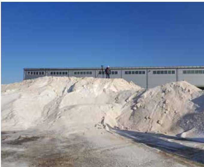
야드에 적재된 소금 스캔 후 볼륨 측정
