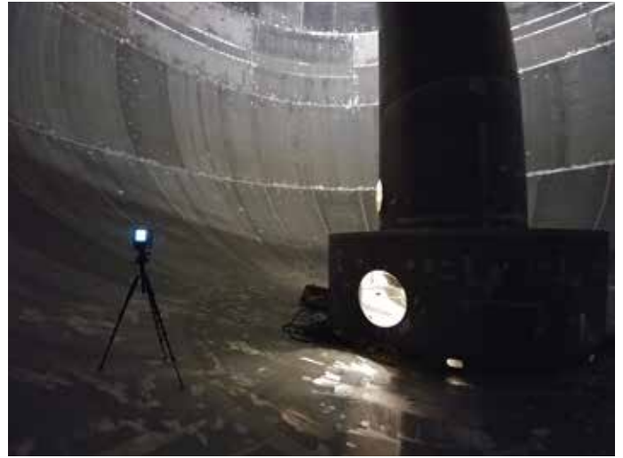
Focus 스캐너로 유조선의 화물창을 스캔하는 모습
