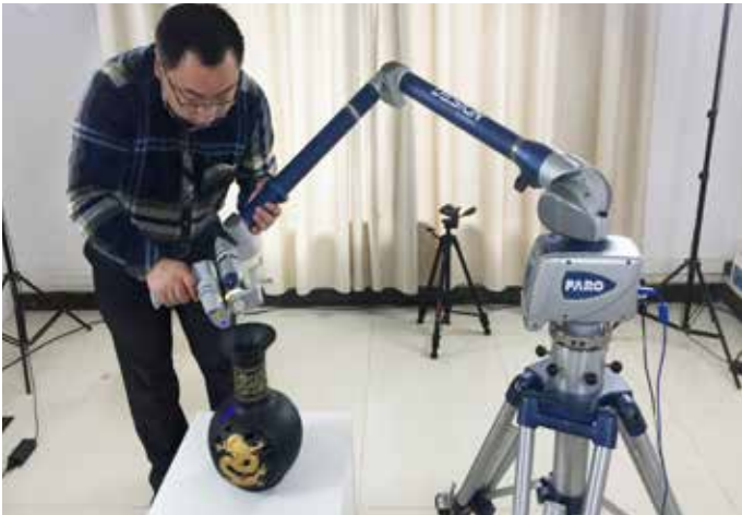
MouRui Technology의 직원은 FARO Design ScanArm을 사용하여 자기로 만든 꽃병을 스캔합니다.
