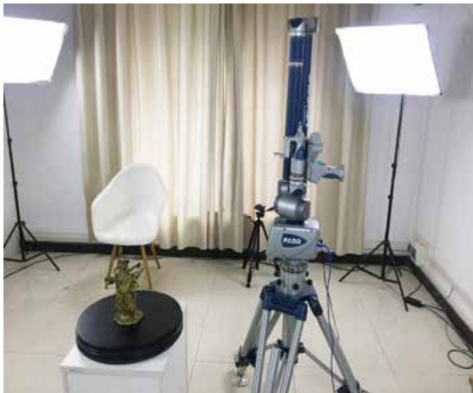
FARO Design ScanArm을 사용하여 청동으로 된 장식을 디지털화 할 수 있습니다.
