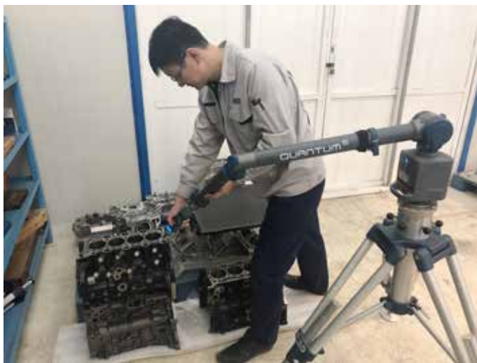
FaroArm으로 초도 생산품 검사 수행
