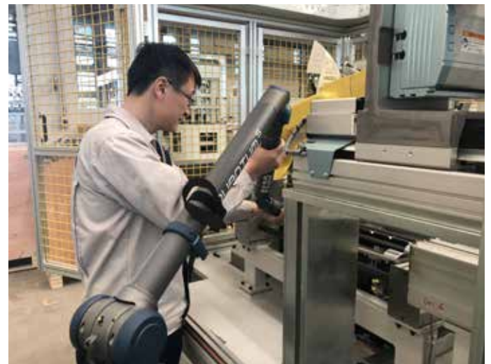
FaroArm을 통해 생산 라인에서 바로 검사를 수행할 수 있게 되었습니다.
