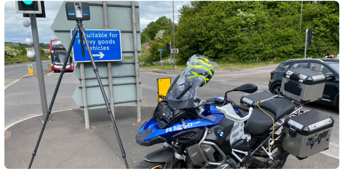
Laserscanner etablieren sich im Bereich öffentliche Sicherheit zunehmend als neuer Standard für die Untersuchung und Analyse von Unfallorten.
