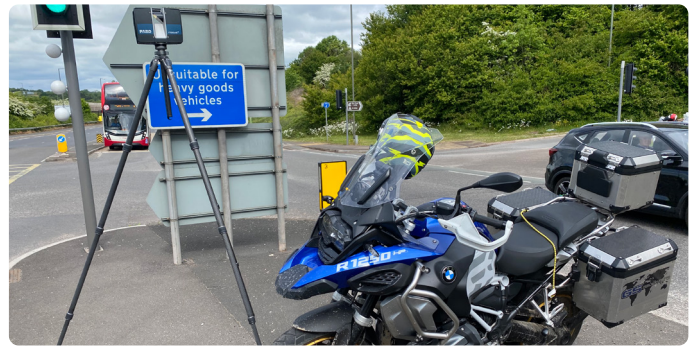
Les scanners laser s'imposent rapidement pour les analyses et enquêtes sur les lieux d'accidents dans le domaine de la sécurité publique.
