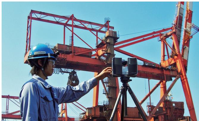
工場設備をFARO Laser Scanner Focus<sup>3D</sup>にてスキャン。屋外でも使用でき、安全な場所からスキャンが可能。
