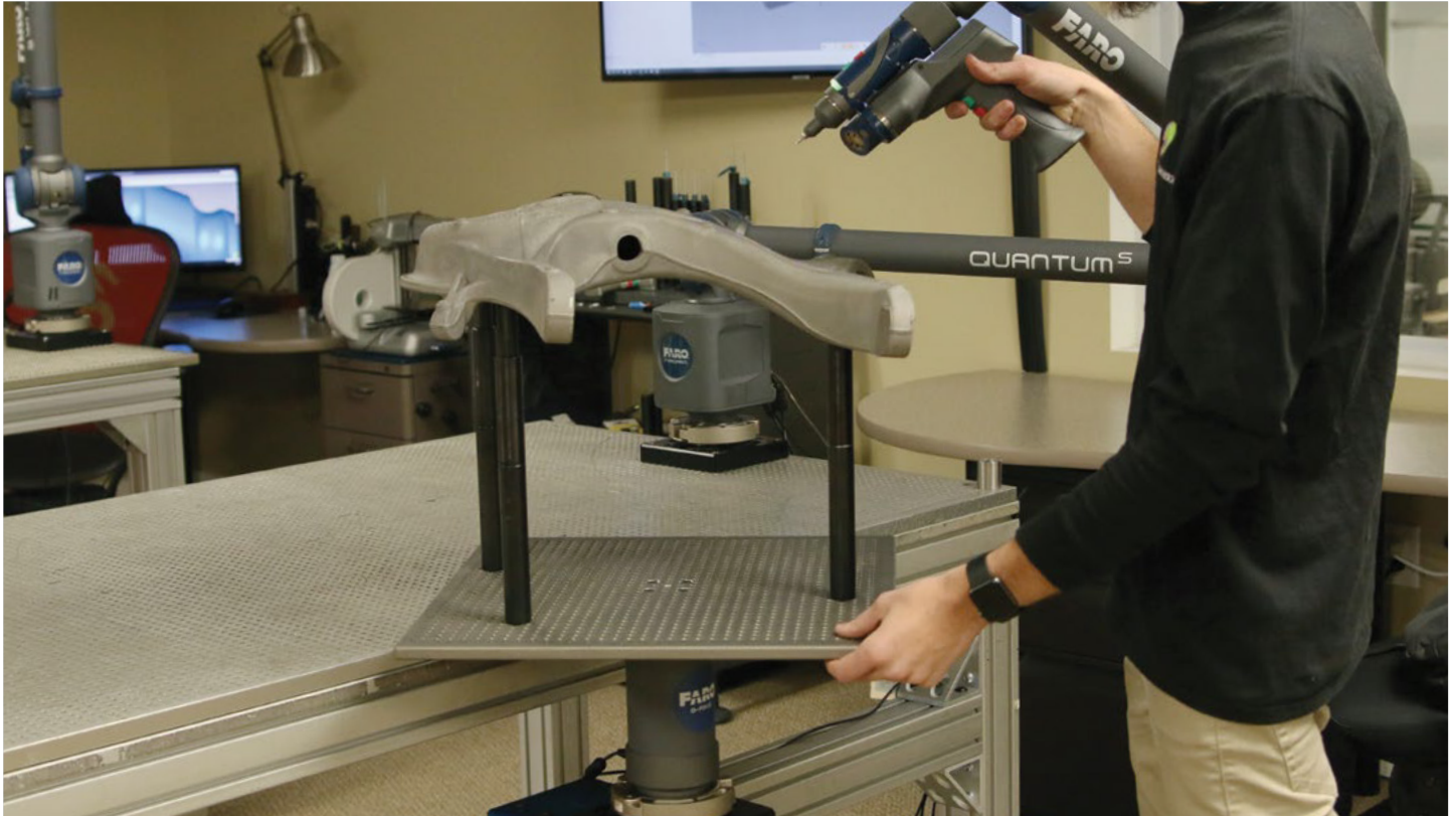
Amos Denbensten, Metrologue à Diverse Dimensions, Numérisation avec 8-Axis Quantum 5 ScanArm
