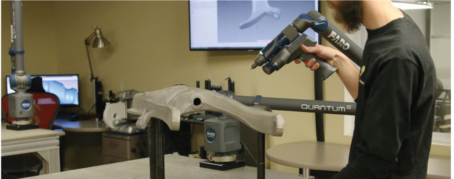
Amos Denbensten, Messtechniker bei Diverse Dimensions, beim Scannen mit dem 8-Axis Quantum 5 ScanArm
