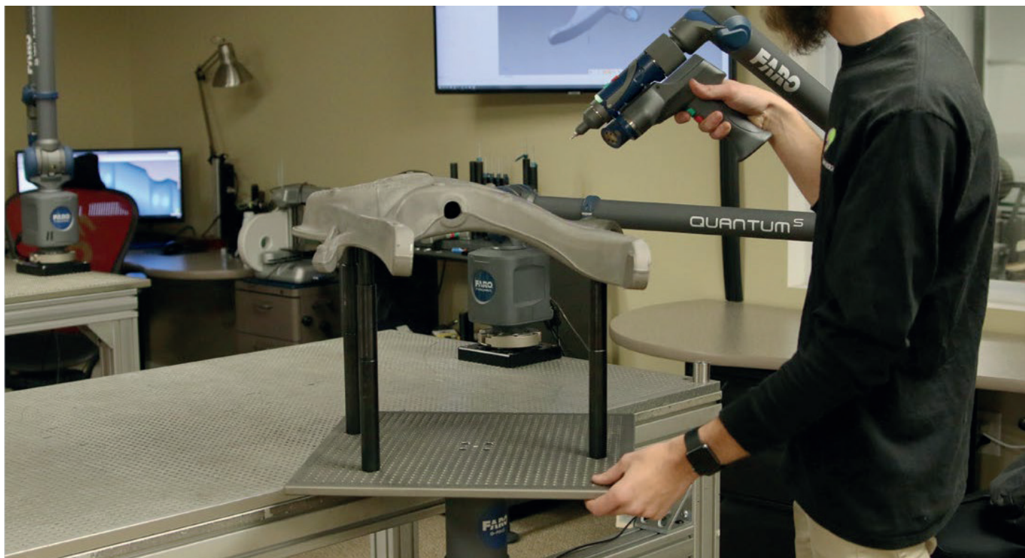
Amos Denbensten, metrologo di Diverse Dimensions, mentre esegue una scansione con il sistema ScanArm Quantum 5 a 8 assi
