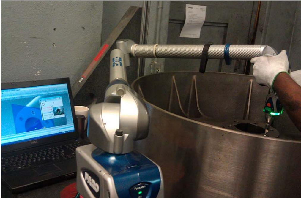
La manovrabilità di CAM2 Edge permette all'operatore di raggiungere tutte le necessarie caratteristiche del pezzo.
