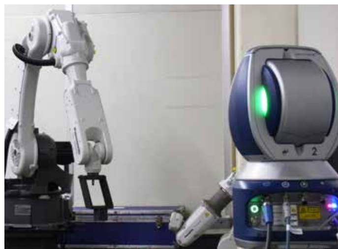
FARO Laser Tracker VantageとBuildIT Metrologyソフトウェアは、ロボットアームの軌跡を高精度に測定。
