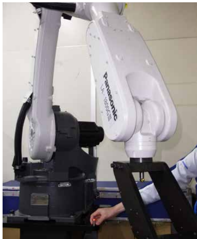
中型多用途ロボットマニピュレータLA-1800の台座を測定。アームの軌跡を測定するためのSMR (レトロリフレクター) も装着されている。
