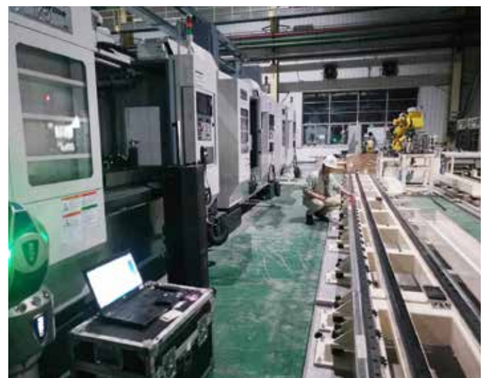
車ドアアセンブリラインの搬出用ガイドレールの現場検査。
