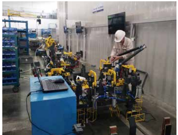
ポータブルなFaroArmを使って、部品をライン上で検査可能。
