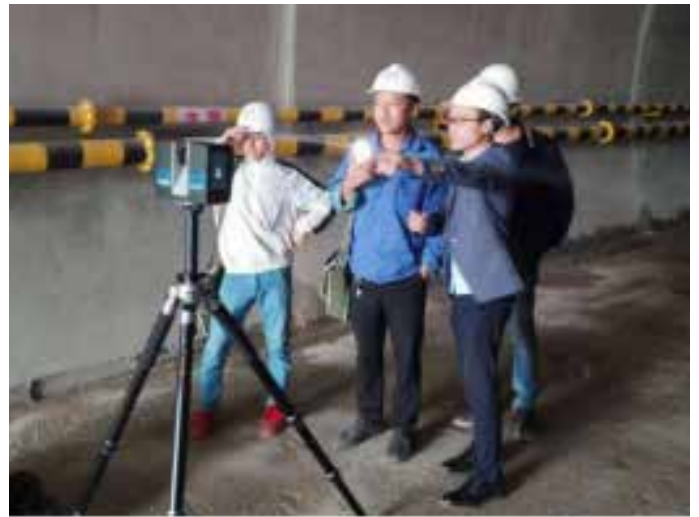
架站式扫描现场正在进行现场测量。
