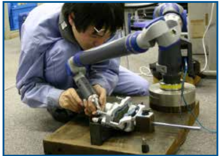
ファローアームを使ったブレーキキャリアの測定
