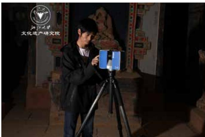
3Dレーザースキャナーを使い、東千仏洞石窟の第7洞窟をスキャン。
