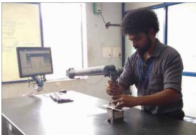
一名操作员使用 FaroArm 的接触式探头检查钣金产品的精确性。
