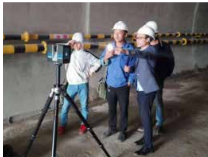
FARO 3Dレーザースキャナーを使って測量作業中。
