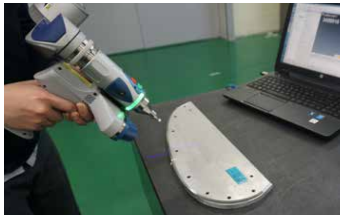
使用 FARO ScanArm 激光扫描仪来检测钛箔。
