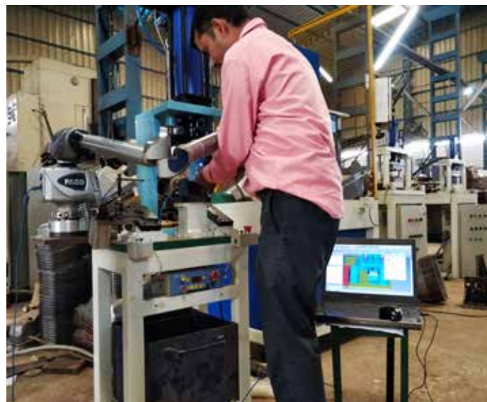
ポータブルなFARO Edgeにより、作業現場のどこでも検査可能。
