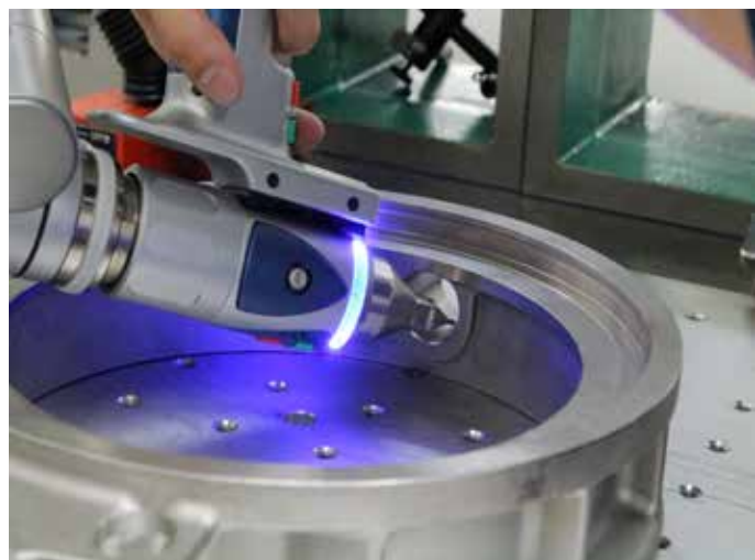
軸穴の偏心量もFaroArmを使えば簡単に測定可能。
