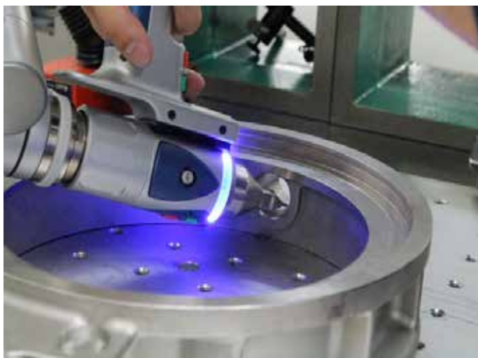
FARO ScanArm 提高了测量的效率和精确性，并提高了阀门的质量。
