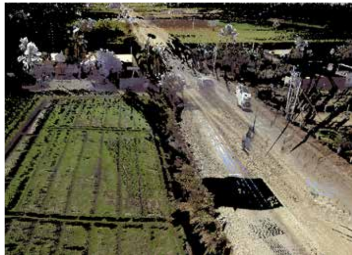
FARO Focus S 330 を使って取得したマハーラーシュトラ地域の未開発道路の 3D 点群データ。
