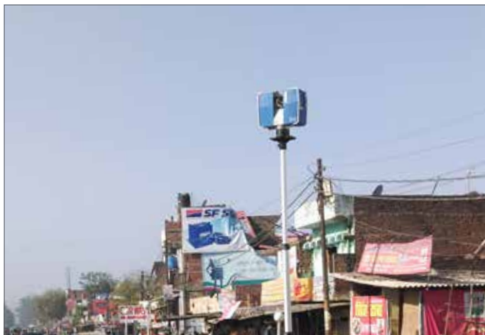
Theotech 采用轻巧灵便的 FARO Focus S 330 开展各种道路测量项目。
