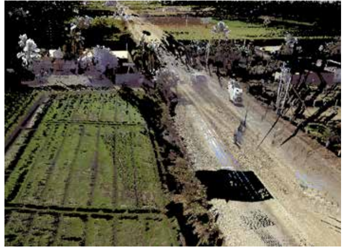
借助 FARO Focus S 330 获得的马哈拉施特拉邦地区新建道路的 3D 点云数据
