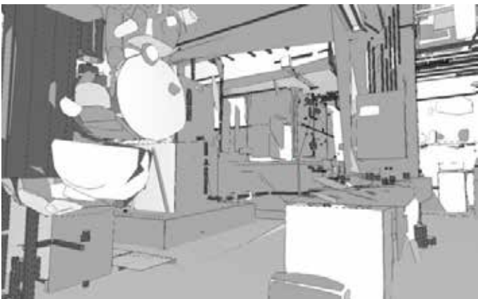
点群データ（上）と、InfiPointsによって自動作成されたサーフェスモデル（下）
