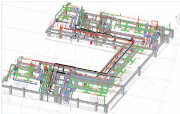
スキャンデータから生成した配管図。
