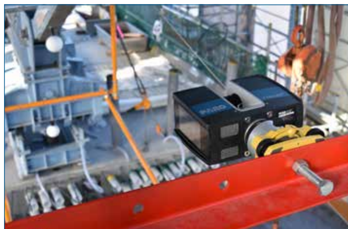
奥に見える橋桁の端面を点群計測中の「Focus s 350」。横向きに設置することで計測時に死角が出ないようにしている
