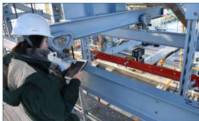
アクセスしにくい場所に設置したFocus s 350は、タブレット端末から遠隔操作できるので安心
